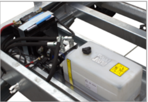
KAUKO-OHJAIMELLA HALLITTAVA SÄHKÖINEN KIPPIPUMPPU - lisävar.
